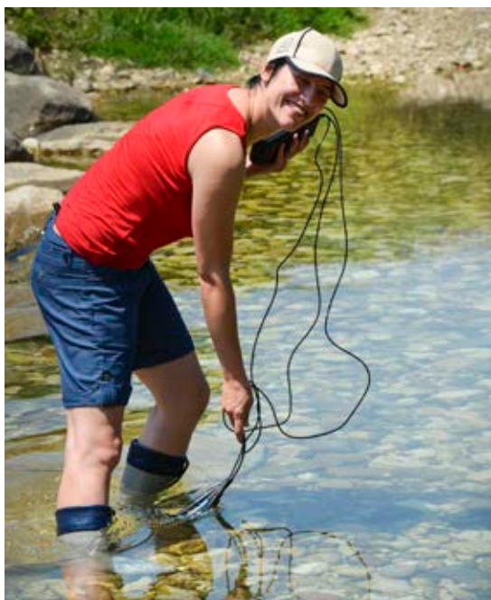
Meritve osnovnih parametrov kakovosti vode na Vipavi v okviru projekta Gotrawama.
