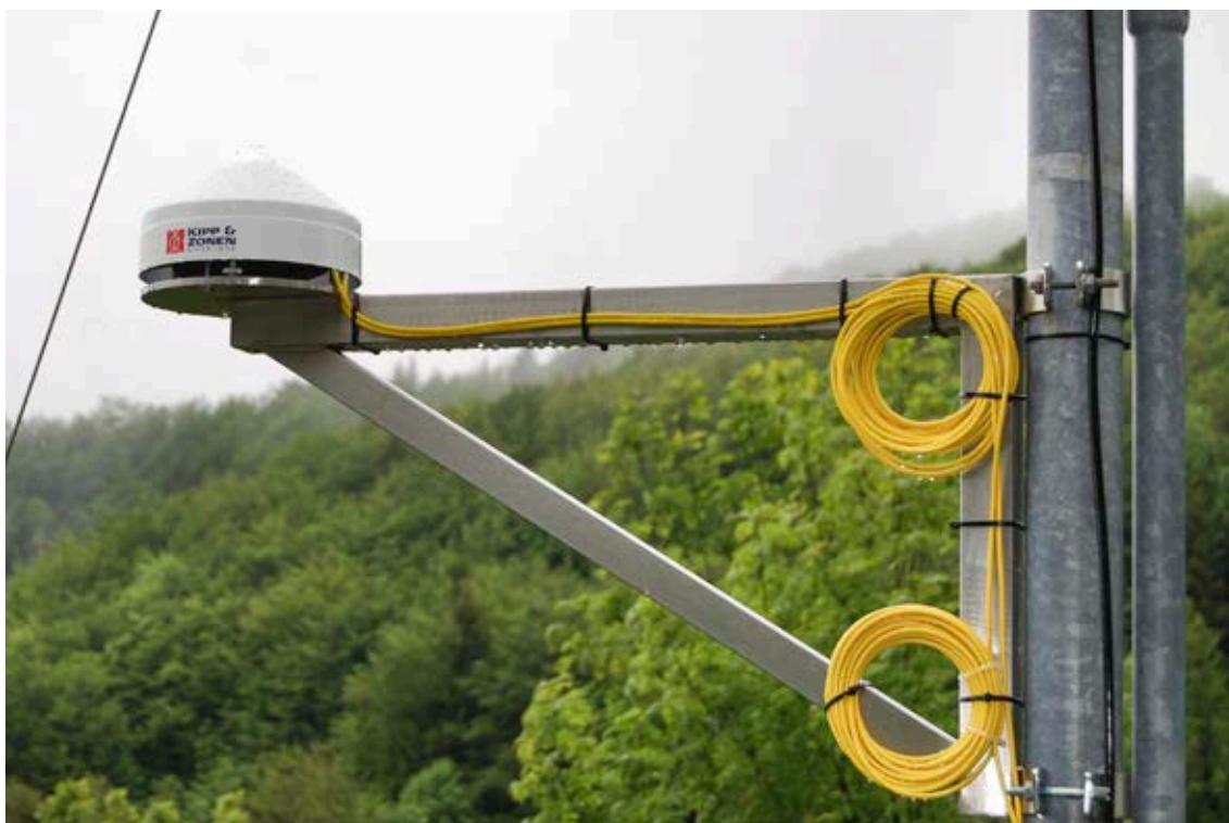
Senzor za meritve Sončnega sevanja v okviru nove meteorološke postaje na observatoriju na Otlici.
