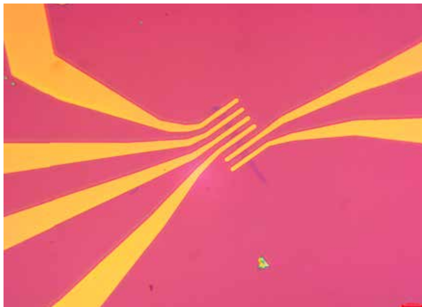
Fotografija enoslojnega grafena narejena z optičnim mikroskopom. Grafen, ki je bil položen na silicijev dioksid je bil pridobljen z mehanskim luščenjem iz kosa grafita. V rumeni barvi so prikazane zlate elektrode, ki smo jih izdelali z lasersko litografijo. Tako izdelan tranzistor z učinkom polja smo uporabili za študij transporta električnega naboja v grafenu.
