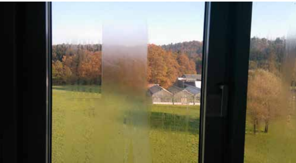
Tanka protizarositvena plast na oknu: manj aktivna levo, bolj aktivna desno, sredina brez prevleke.
