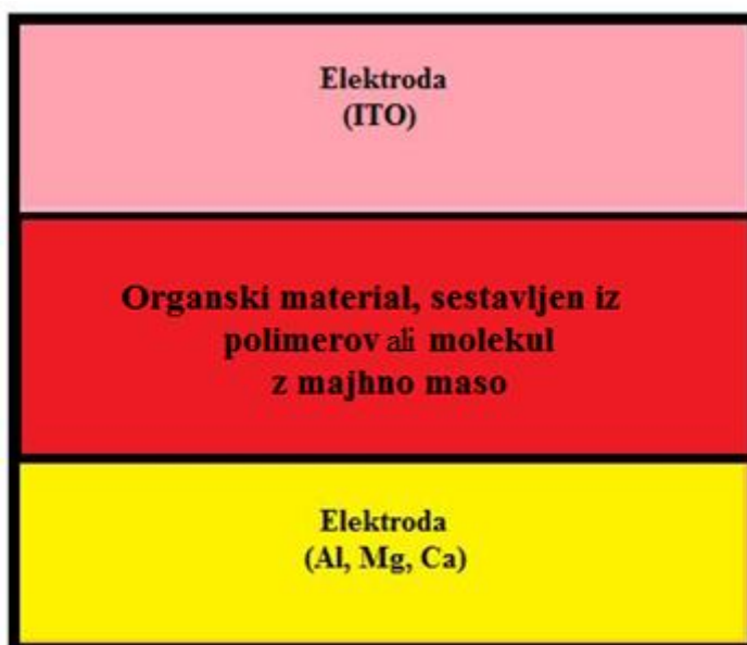
Slika 2. Enoslojna organska sončna celica in njene komponente.
