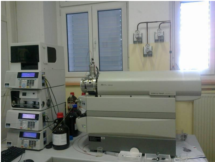
Slika 9: Tekočinski kromatograf z masnim spektrometrom (LC-MS) (Foto: Žabar, R., 2012)
