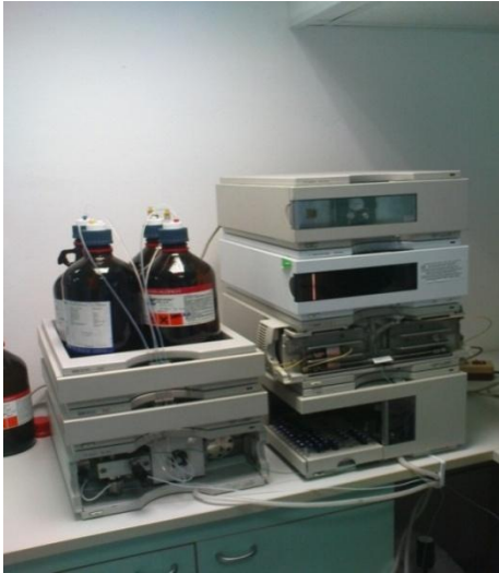
Slika 8: Tekočinski kromatograf visoke ločljivosti (HPLC) z DAD detektorjem (Foto: Krašovec, B., 2011)
