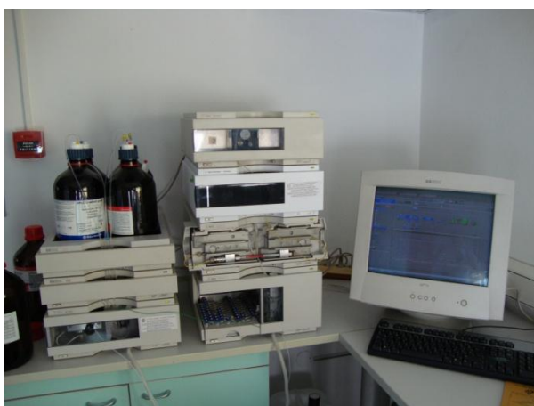
Slika 10: Visokotlačni tekočinski kromatograf (HPLC) v laboratoriju na Univerzi v Novi Gorici (fotografija: Tjaša Simčič, 2012)
