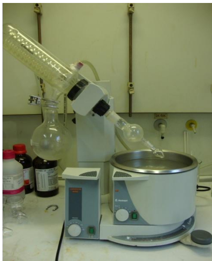
Slika 9: Rotacijski vakuumski uparjevalnik (rotavapor) (fotografija: Tjaša Simčič, 2012)
