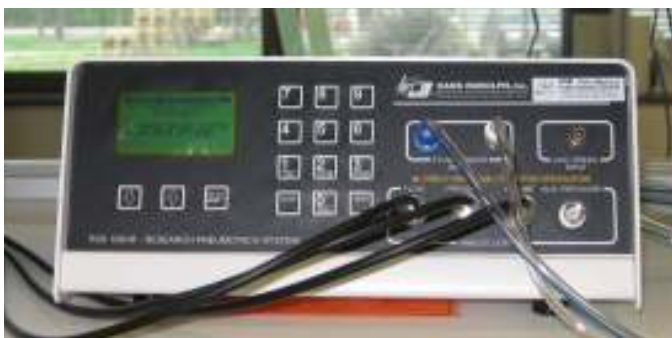
Slika 19: Pnevmtah, naprava za merjenje volumna zraka.
