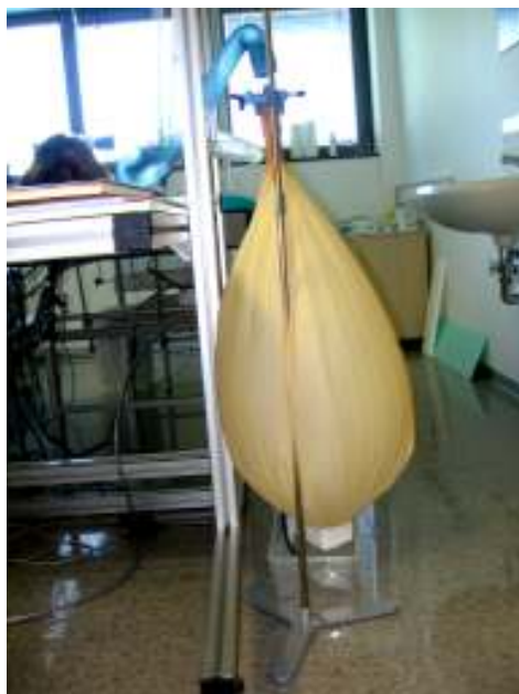
Slika 9: Meteorološki balon. Z meteorološkim balonom smo preiskovancem omogočali spontano dihanje ne glede na to, ali so dihali običajen zrak ali pa hipoksično dihalno mešanico.
