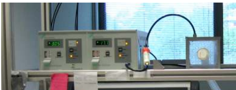
Slika 18: Plinski analizator in mešalna škatla, v kateri smo zbirali izdihani zrak.
