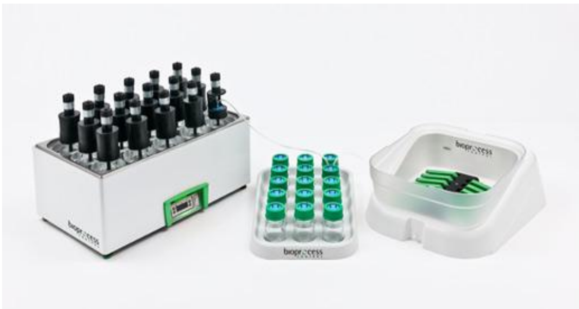
Slika 8: Naprava za določanje bioplinskega potenciala (Bioprocess Control, 2010)
