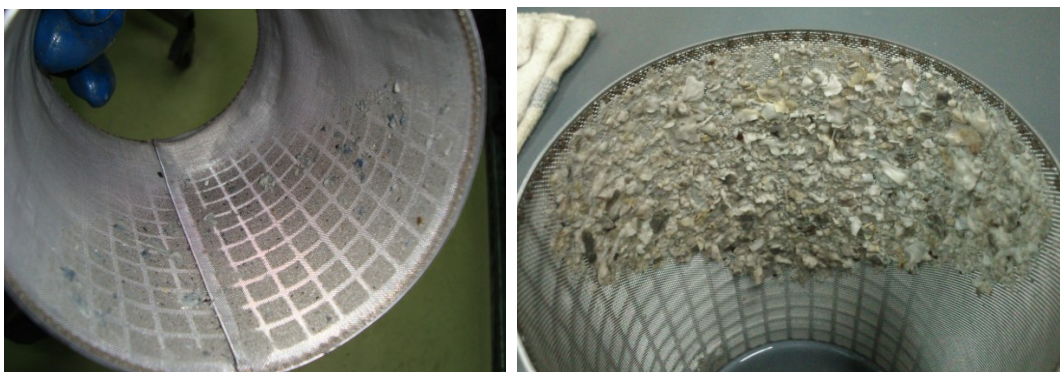
Slika 35: Primerjava onesnaženosti mrežice pred membranskih procesom pri manjši (levo) in večji obremenjenosti odpadnih vod (desno)
