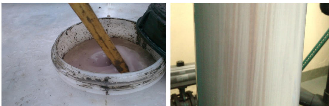
Slika 28: Z US 620 obremenjene odpadne vode (levo) in trajna obarvanost membran (desno)
