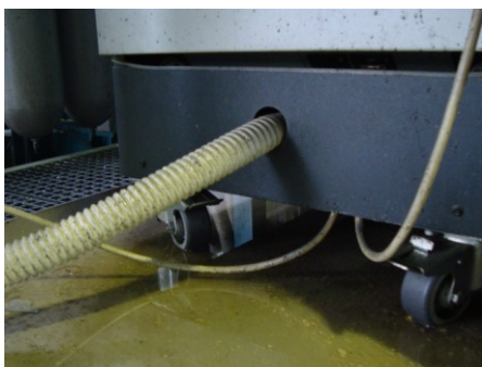
Slika 15: Lovilnik olja (Transtherm 525) pod grelno napravo
