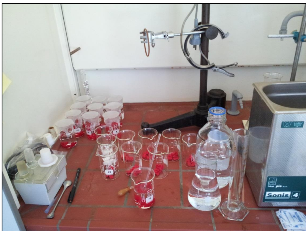
Slika 7: Izpostavitve vlaknen PET in acetatne celuloze nasičenim vodnim raztopinam triklosana
