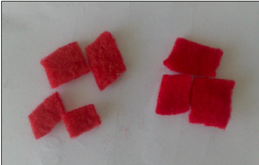
Slika 12: Slika staranega PET (levo) in novega PET (desno). Vidno je, da so starana vlakna spremenila barvni ton in postala svetlejša.
