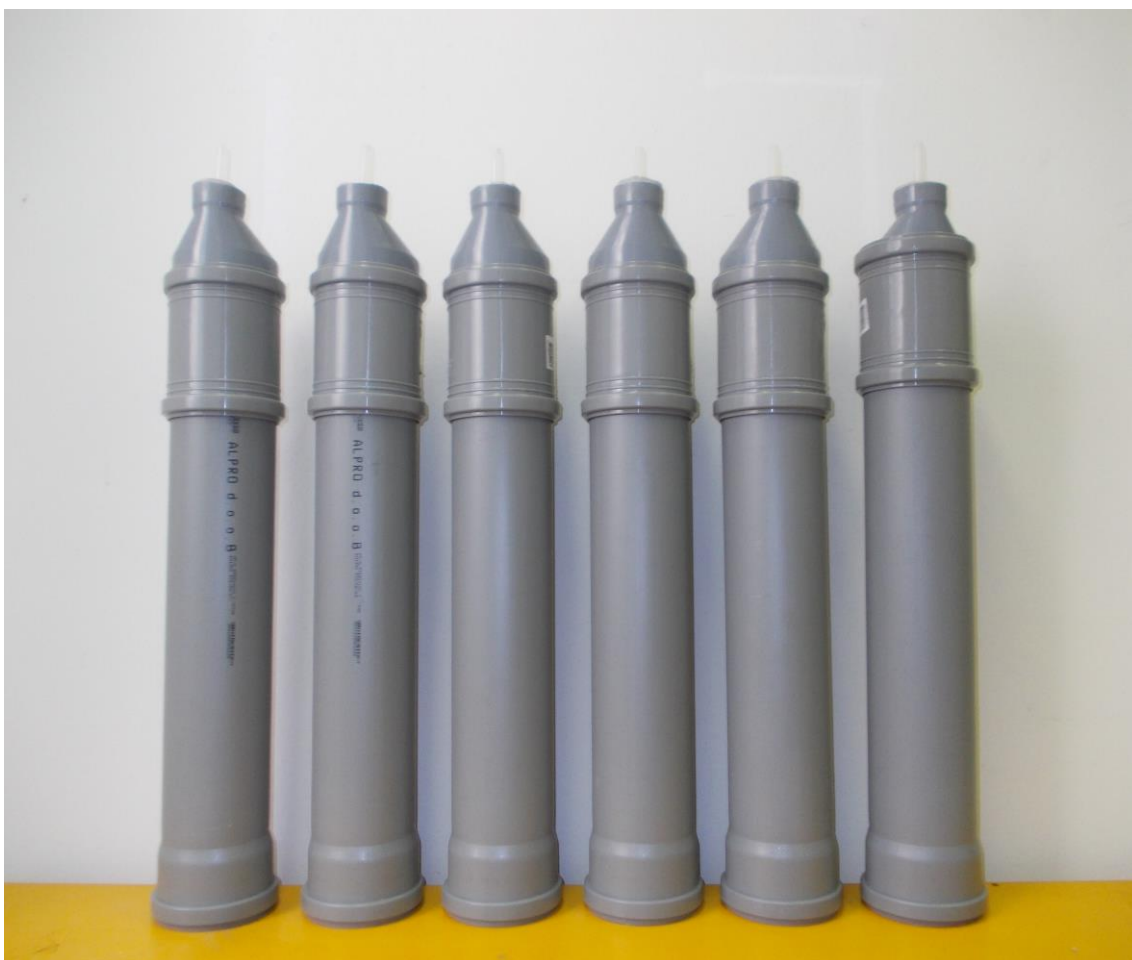
Slika 11: Sestavljene kolone iz polipropilenskih kanalizijskih cevi
