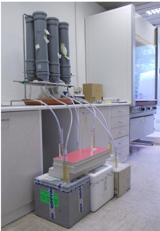
Slika 13: Potek zbiranja vzorcev v 100 mL merilne valje
