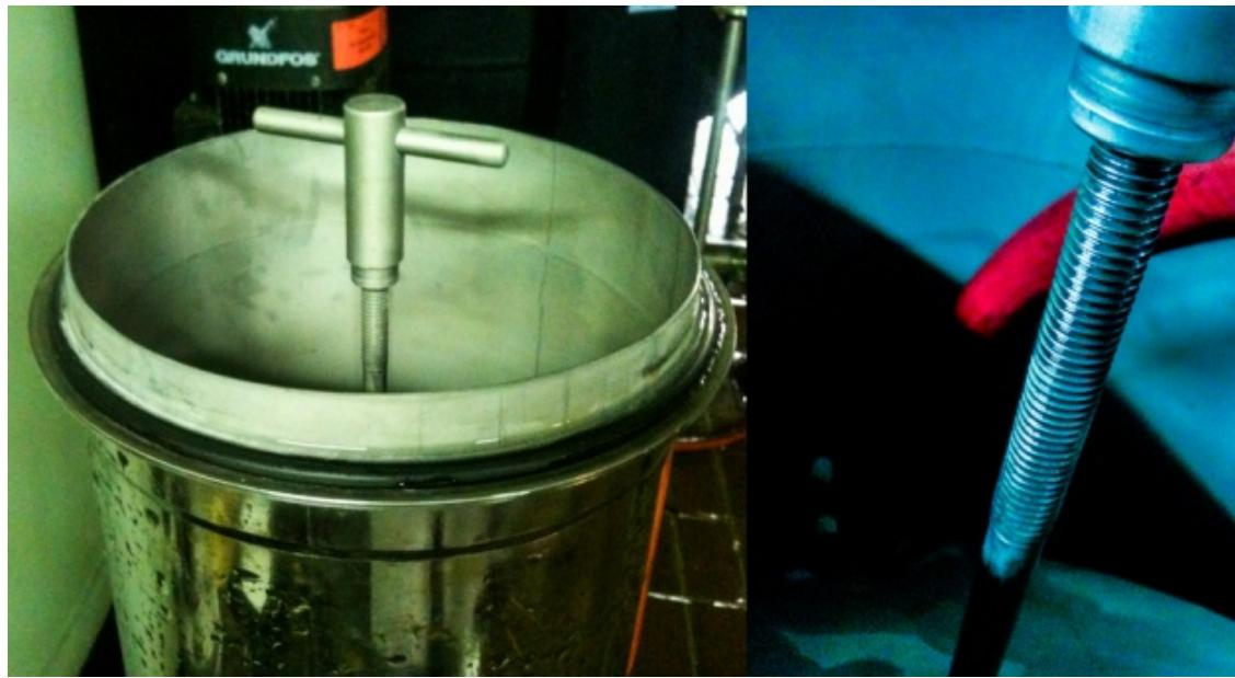
**Slika 11:** Nabiranje karbonata na jeklu pilotnega reaktorja za obarjanje
