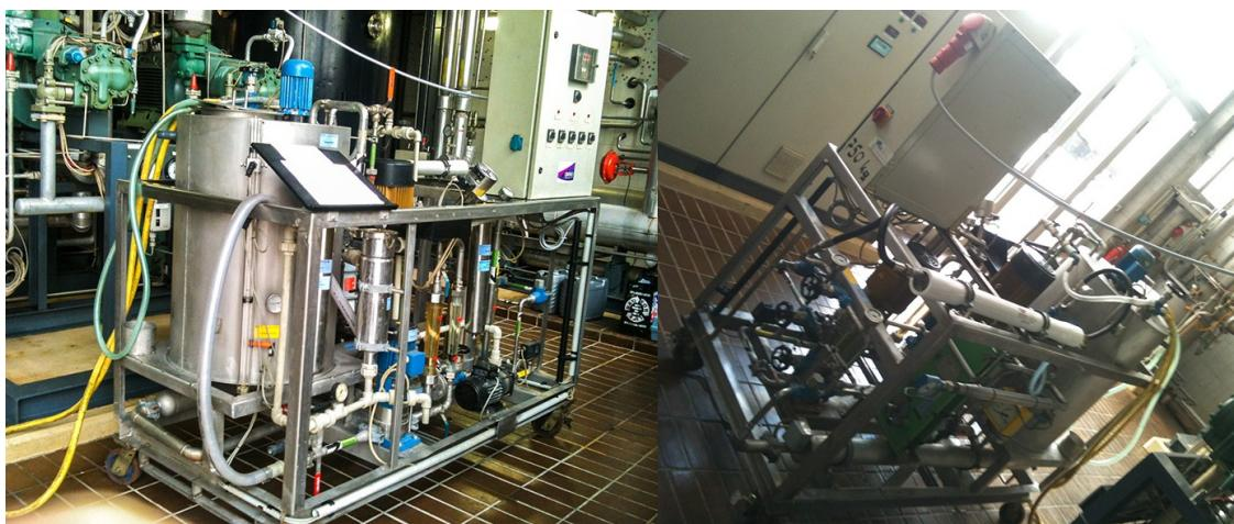
*Slika 5: Pilotna naprava RO*
