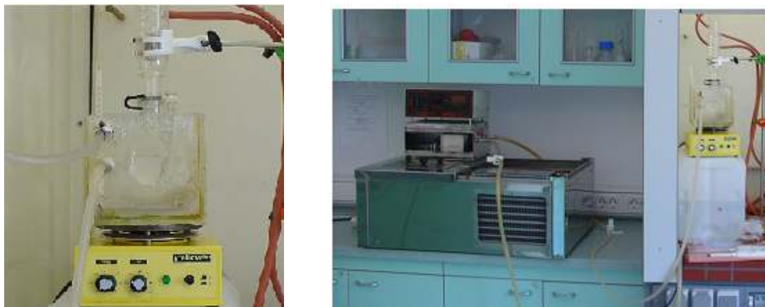
Slika 16: Šaržni reaktor (levo) in njegova povezava s termostatom preko pritočne in iztočne gumijaste cevke (desno)
