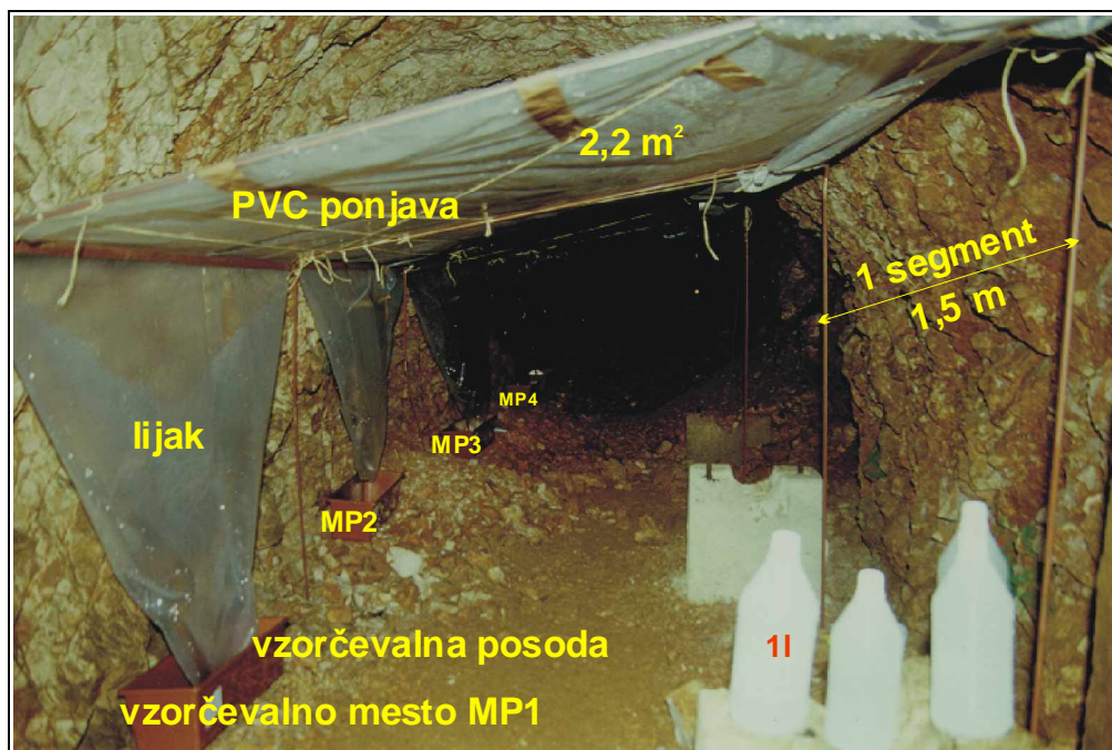
Slika 13: Konstrukcija v rovu 13:119
