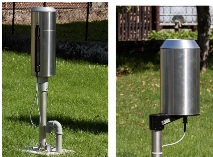
Slika 7: Tehtalni ombrometer za merjenje padavin (levo) in ombrometer na prekucno posodo (desno) (meteolab, 2014)
