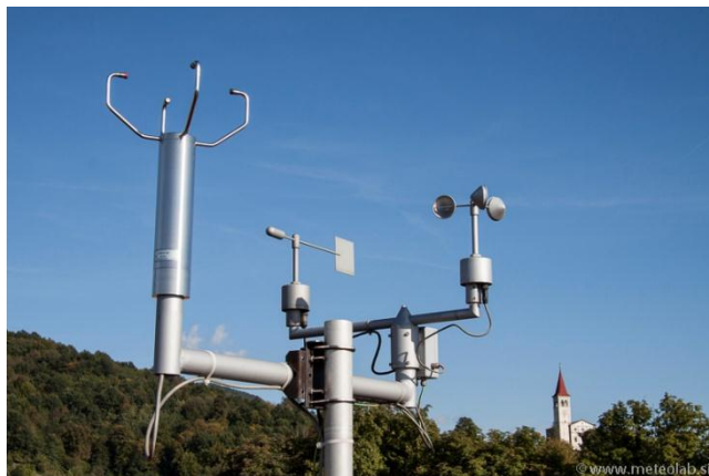
Slika 8: Primer ultrazvočnega anemometra (levo) in anemometra na vrtljive čaše (desno) skupaj z vetrokazom (sredina) (meteolab, 2014)
