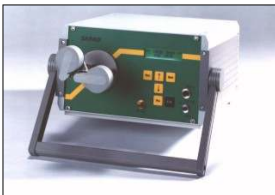
Slika 5. Kontinuirni merilnik radona in njegovih razpadnih produktov EQF 3020-2. (Sarad Instruments...EQF 3020)
