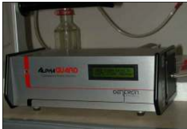
Slika 7. Kontinuirni merilnik radona AlphaGuard (Genitron Instruments, 1998).
