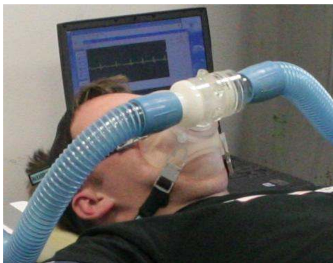
Slika 9: Maska z ventili za enosmerni pretok zraka. Maska onemogoča povratni tok zraka med dihanjem preiskovanca.
