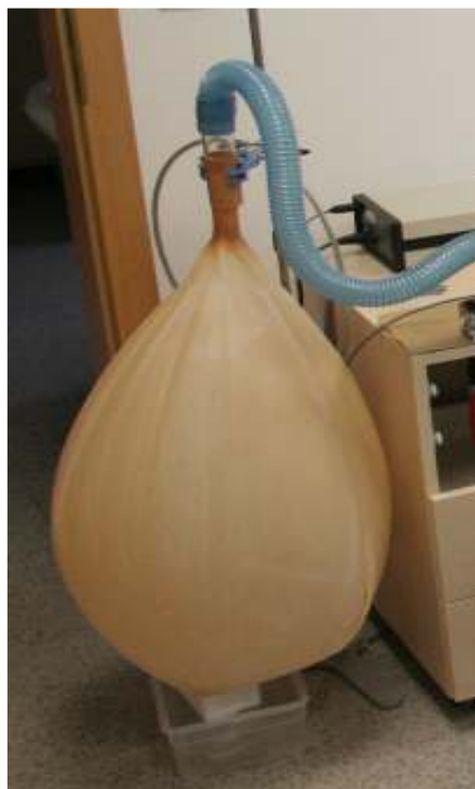
Slika 10: Meteorološki balon. Balon omogoča vlaženje vdihanega zraka in zmanjša tlak plinske mešanice na vrednost okoljskega tlaka.
