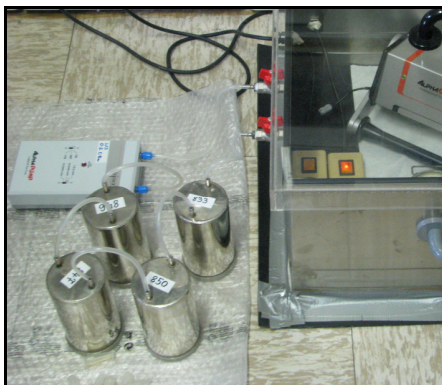
Slika 17: Odvzem vzorca zraka iz komore hkrati v 4 stare celice, ki so zaporedno povezane s komoro in črpalko.
