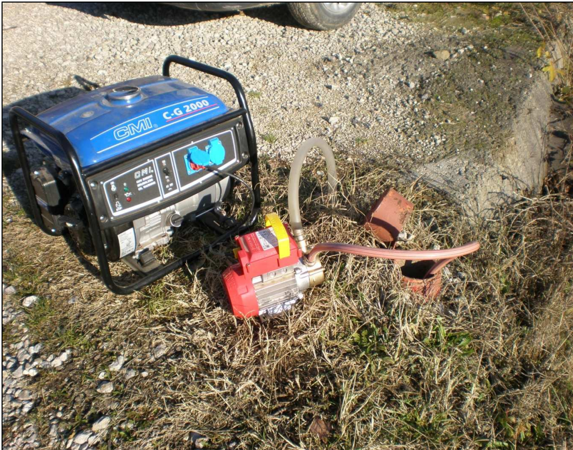
Slika 23: Vzorčevanje vode na piezometru P5
