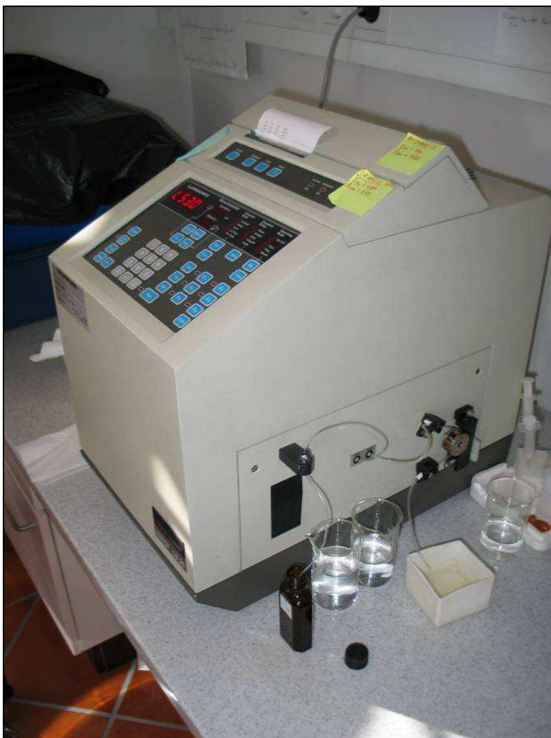
Slika 24: Spektrofluorometer Perkin Elmer LS 30 4T z vzorcem med analizo
