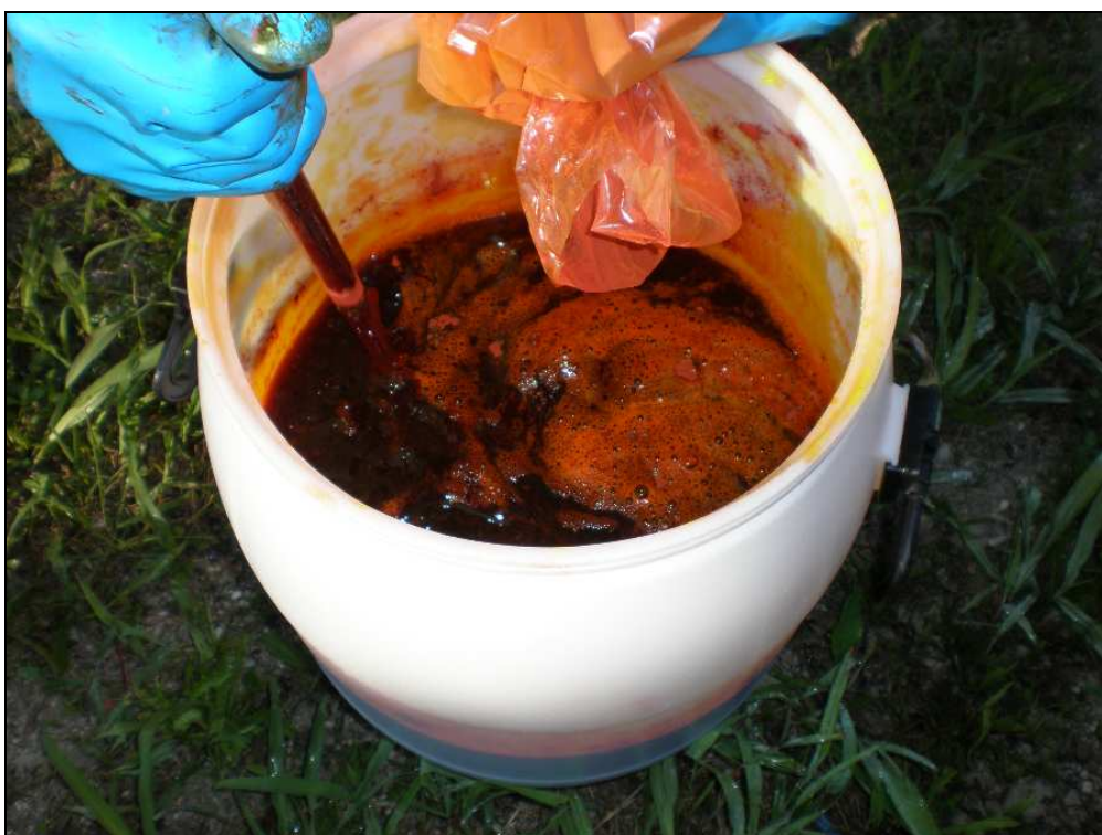
Slika 21 : Priprava sledila – raztapljanje uranina
