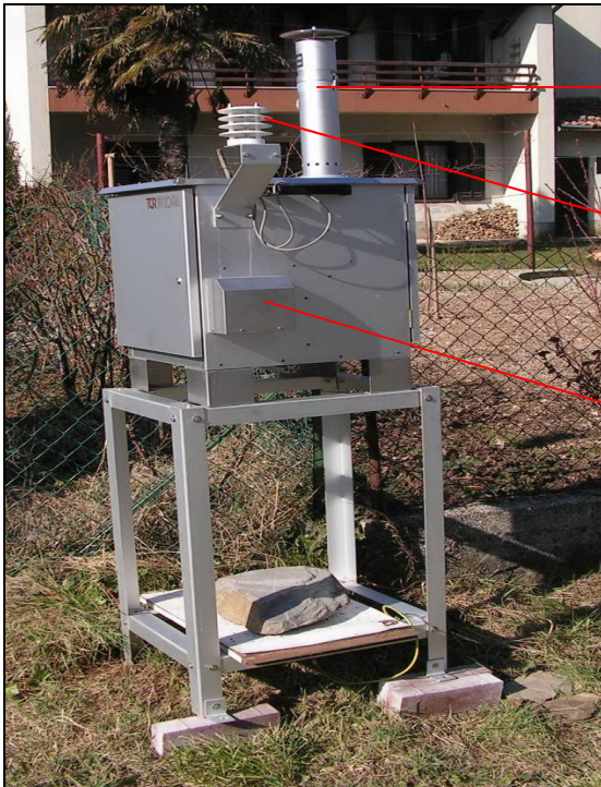
Slika 20: Sestavni deli merilnika Tecora Skypost PM/HV
