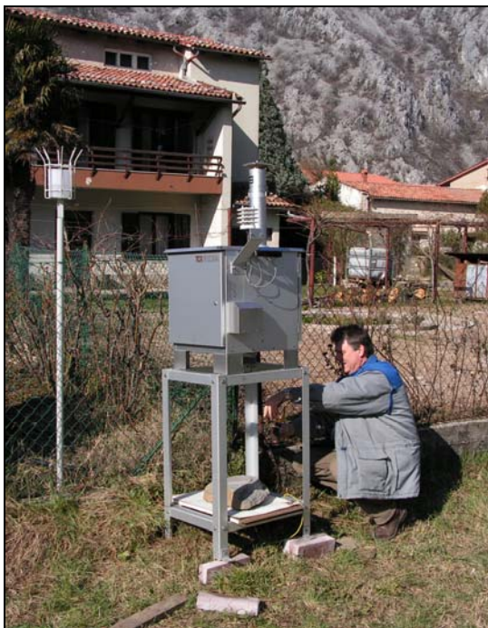
Slika 29: Postavitev merilnika Tecora Skypost PM/HV
