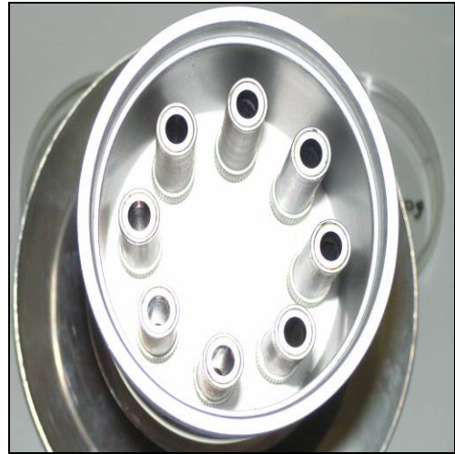
Slika 19: Ciklon, skozi katerega potujejo delci manjši od 10\ \mu\text{m}
