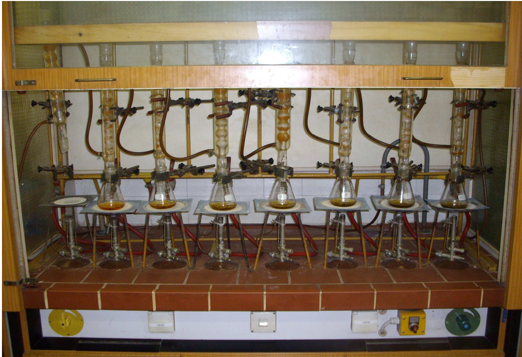
Slika 9: Določevanje KPK v laboratoriju (odpadne vode)
