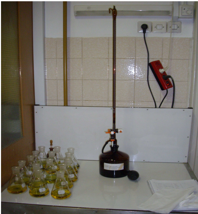
Slika 10: Pripravljeni vzorci za titracijo
