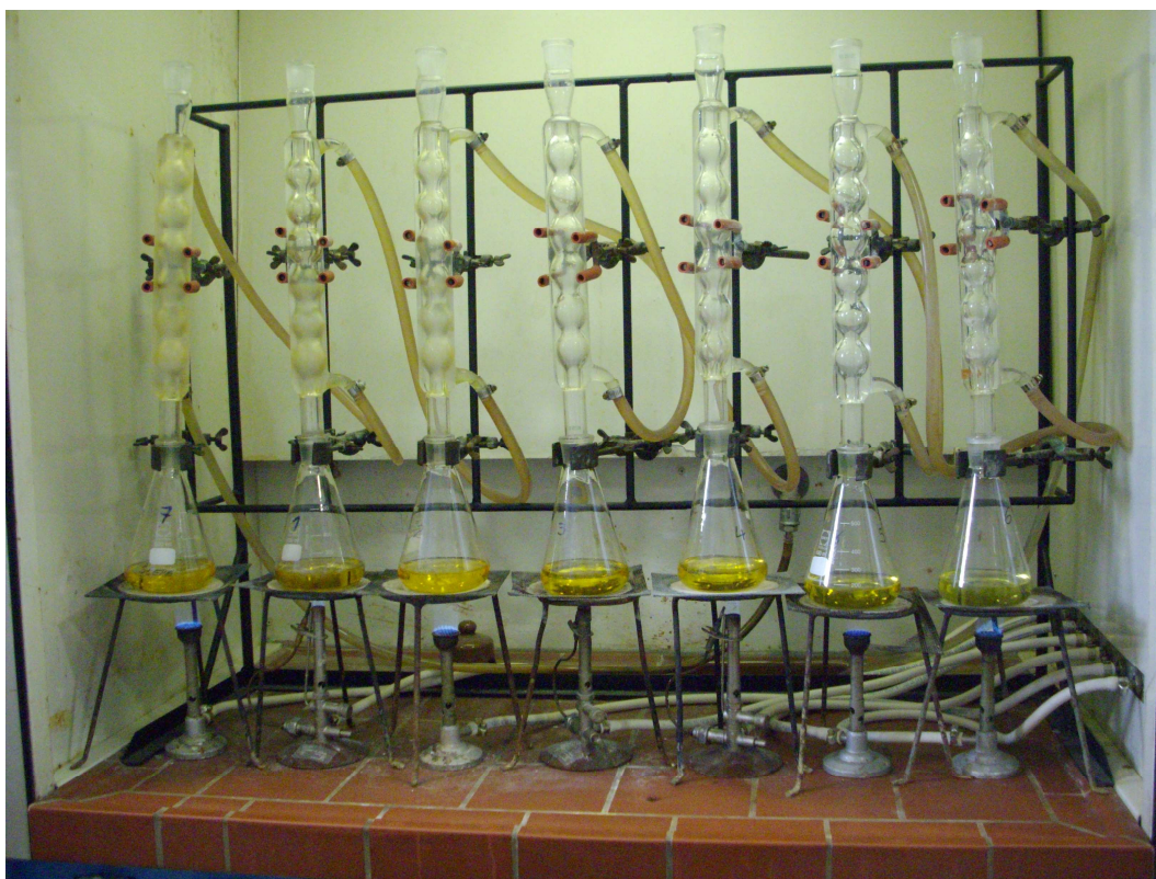
Slika 11: Določevanje KPK v laboratoriju (površinske vode)
