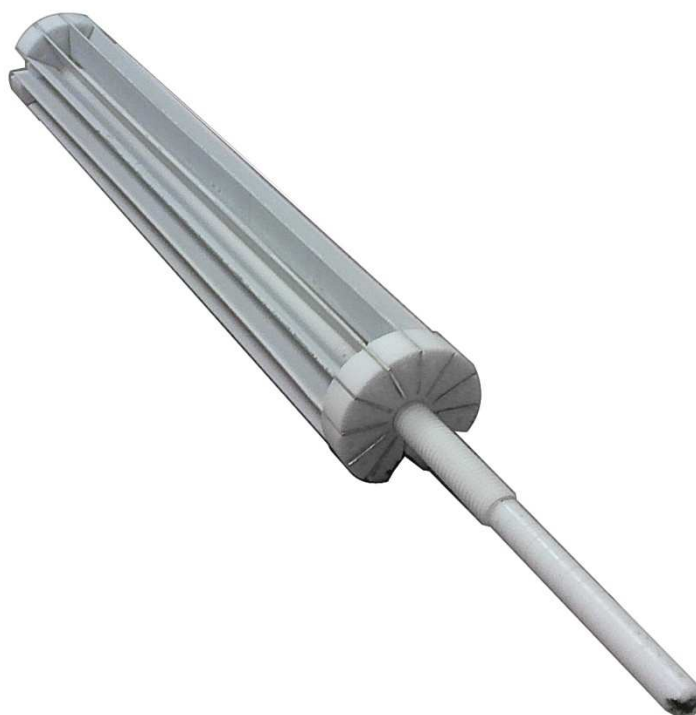
Slika 17: Ploščice s imobiliziranim katalizatorjem na teflonskem nosilcu
