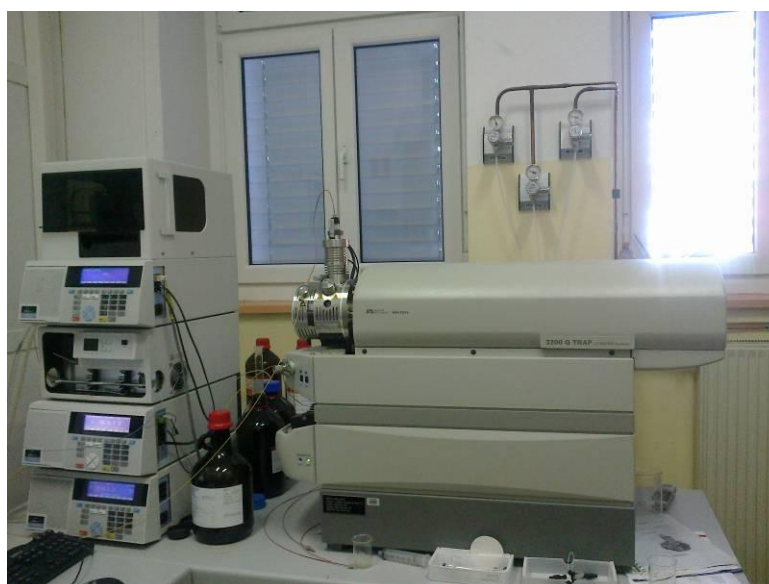
Slika 5: Tekočinski kromatograf z masnim spektrometrom (LC-MS) (Foto Žabar R., 2011)
