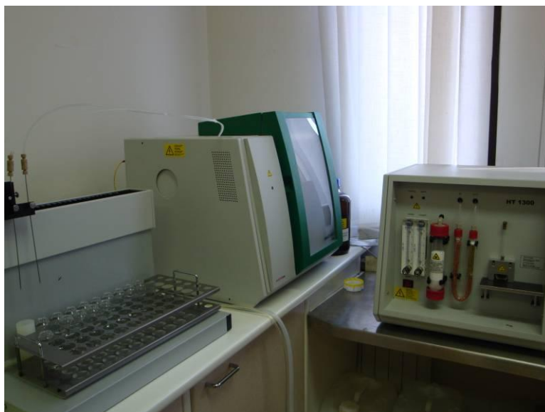
Slika 4: Instrument za določanje skupnega organskega ogljika (TOC) (Foto Rotar M., 2011)
