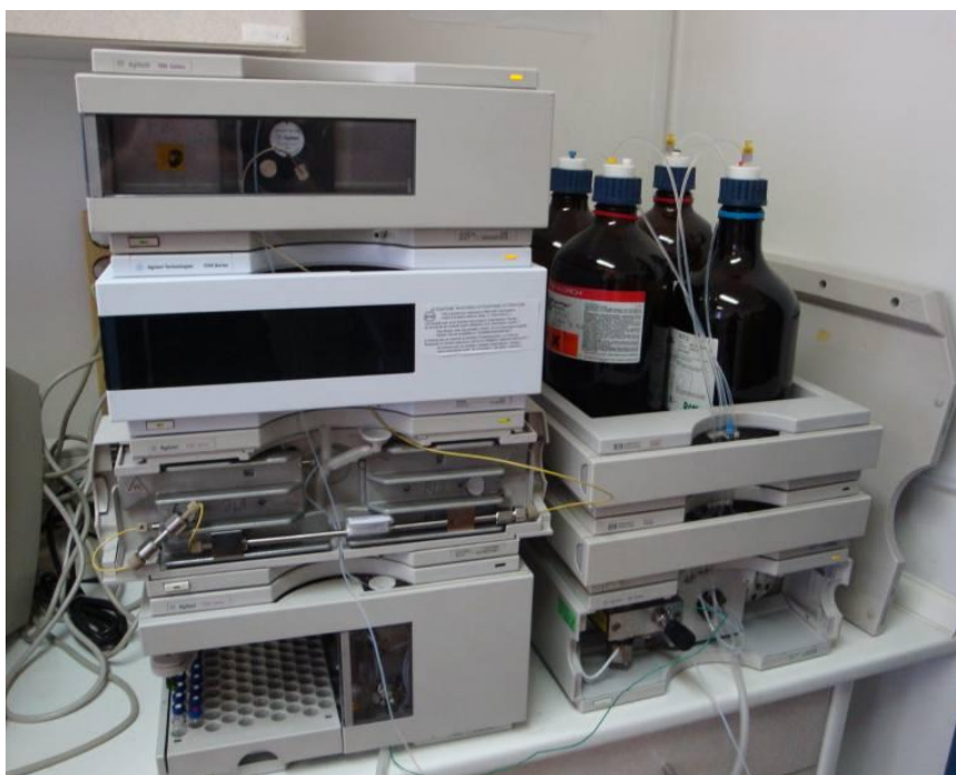
Slika 3 : Tekočinski kromatograf visoke ločljivosti (HPLC) z DAD detektorjem (Foto: Rotar M., 2011)
