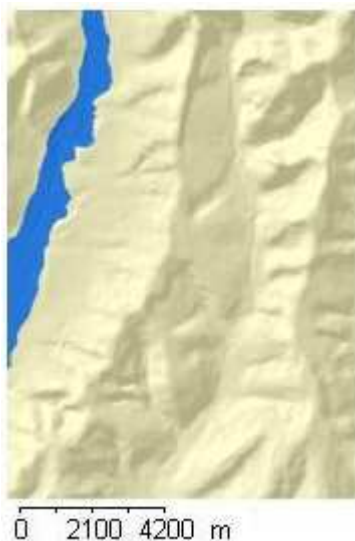
Slika 13: Prikaz sloja poplavnega območja z dvema vrednostma: poplavnim območjem (modra) in okolico (rumena)
