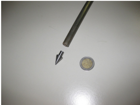
Slika 13: Cev za jemanje vzorcev zraka in kovinska glavica.
