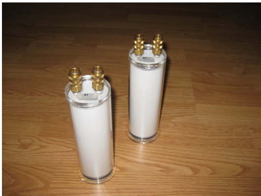
Slika 17: Alfa scintilacijski celici volumna 0,31 \text{ dm}^3 .
