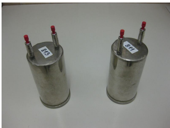
Slika 18: Alfa scintilacijski celici volumna 0,70 \text{ dm}^3 .
