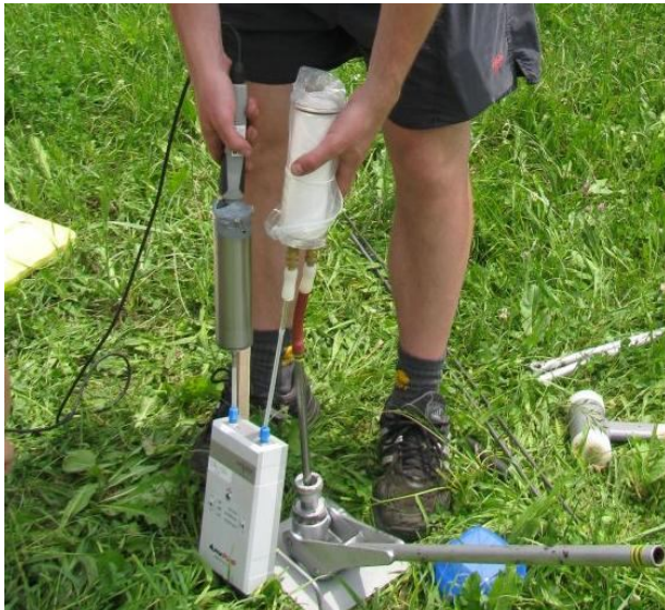
Slika 14: Črpanje vzorca talnega zraka v scintilacijsko celico in preko merilnika \text{CO}_2 s pomočjo črpalke AlphaPump.
