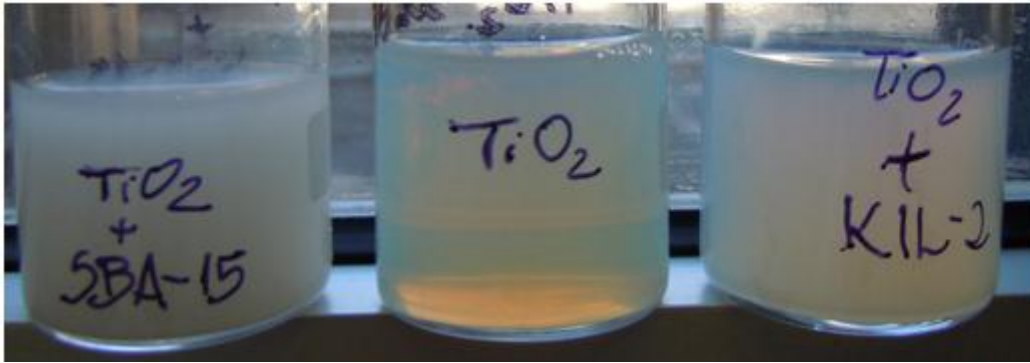
a) b) c) Slika 15: Slika solov pred in po dodatku silicijevega dioksida: \text{TiO}_2/\text{SBA-15} (a), \text{TiO}_2 (b), \text{TiO}_2/\text{KIL-2} (c)
