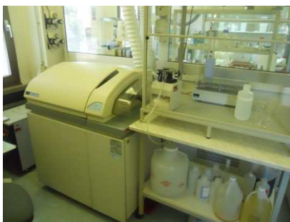
Slika 26: Masni spektrometer z induktivno sklopljeno plazmo (Kemijski analitski laboratorij, ARSO)
