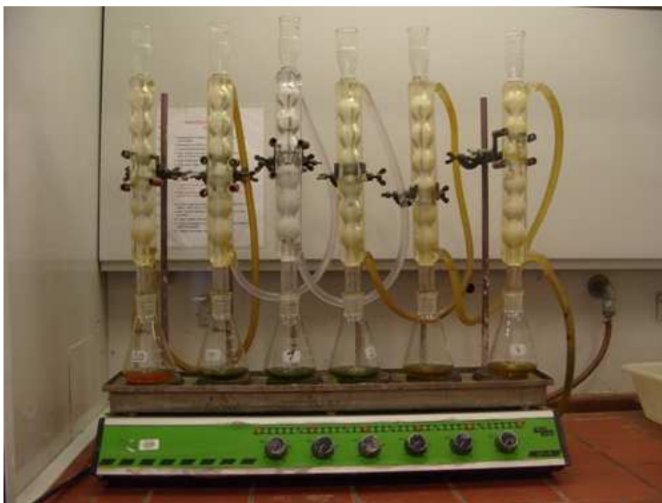
Slika 7: Naprava za kuhanje vzorcev pri analizi KPK
