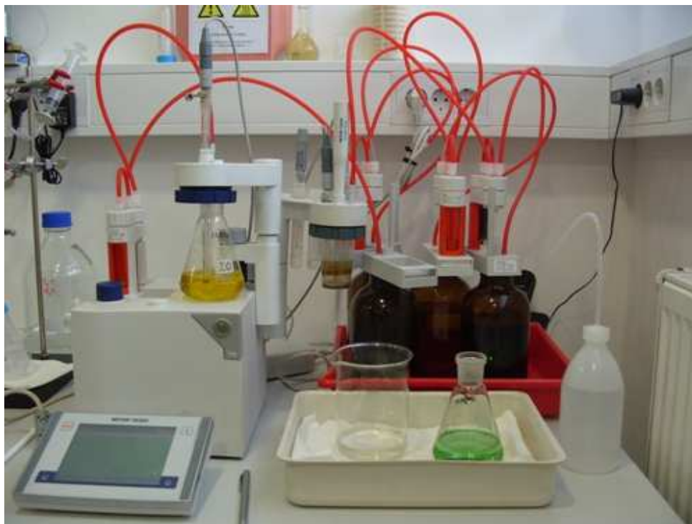
Slika 8: Naprava, ki smo jo uporabili za titracijo vzorcev pri analizi KPK
