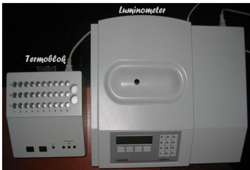
Slika 15: Termoblok in luminometer proizvajalca Dr. Lange za izvedbo testa zaviranja luminiscence bakterij Vibrio fischeri (Vir: http://www.dekonta.cz/en/services-and-products/laboratory-sevices/laboratory-equipment.html , junij 2011)
