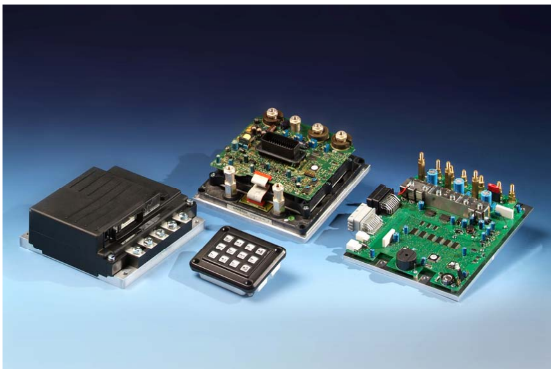
Slika 1: Elektronsko krmilje za krmiljenje motorja pogona ter hidravlike viličarja (Pogonski, 2008)
