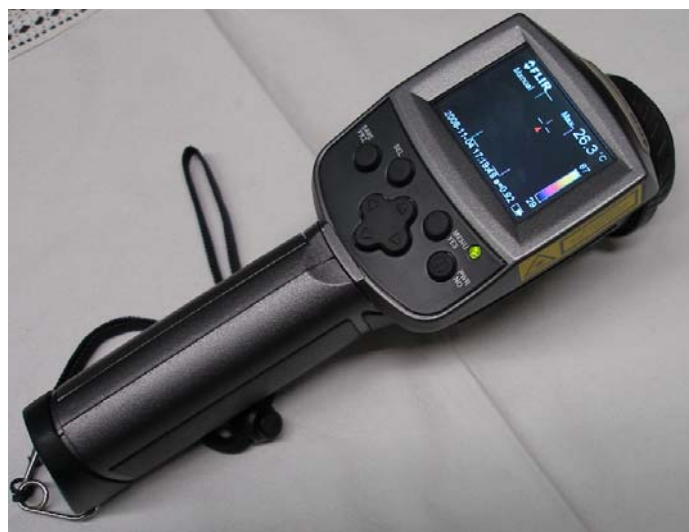
Slika 21: Termografska kamera proizvajalca FLIR Systems, ThermaCam E65
