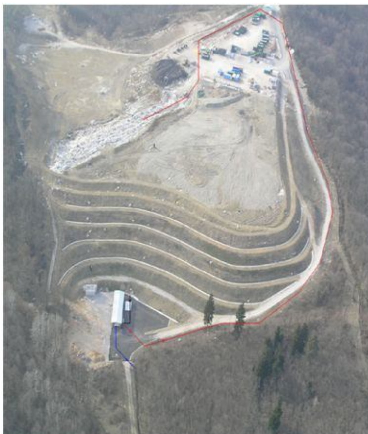
Slika 6: Odvod izcednih vod v čistilno napravo (Komunala, 2008c)
