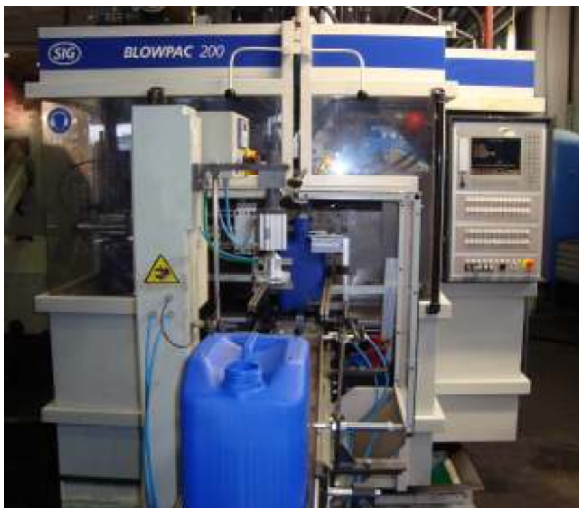
Slika 31: Ograditev območja za zaščito kalupa na stroju za pihanje (Gerbec,2009)
