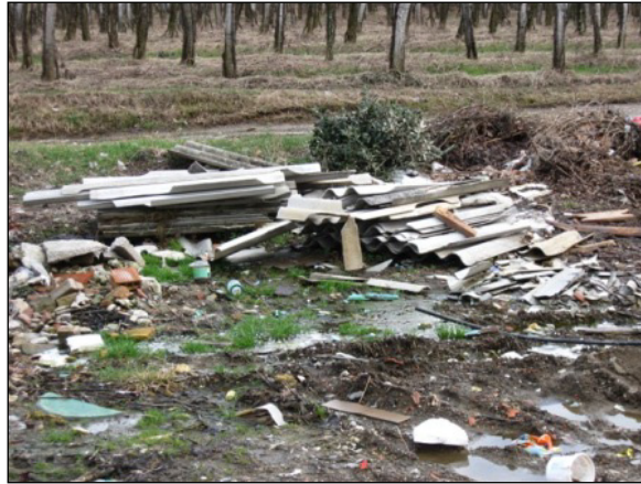
Slika 14: Nepravilno odložene azbestne plošče
