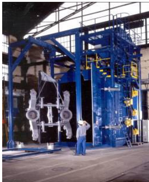
Slika 38: Peskalni stroji z visečo progo VK
