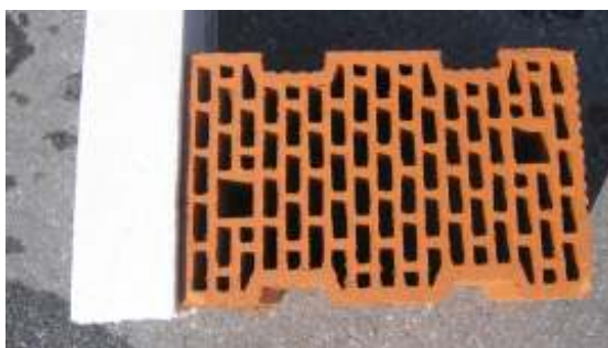
Slika 6: Termo blok s toplotno izolacijo (lastna raziskava)
