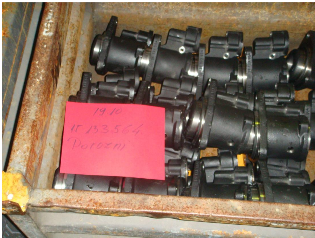
Slika 13: Reklamirani obdelani odlitki kooperanta zaradi poroznosti
