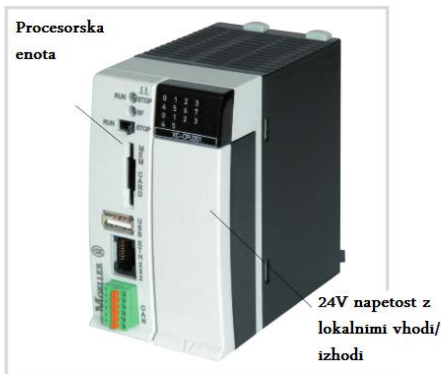
Slika 3.2: Zunanost centralno procesne enote modula XC-CPU201
