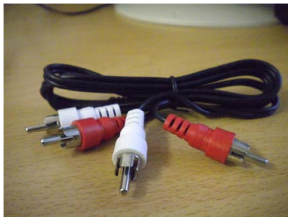
Slika 9.3: Avdio kabel (4 x vmesnik RCA vtičač) za povezavo med motorjem in vmesnikom krmilnika
