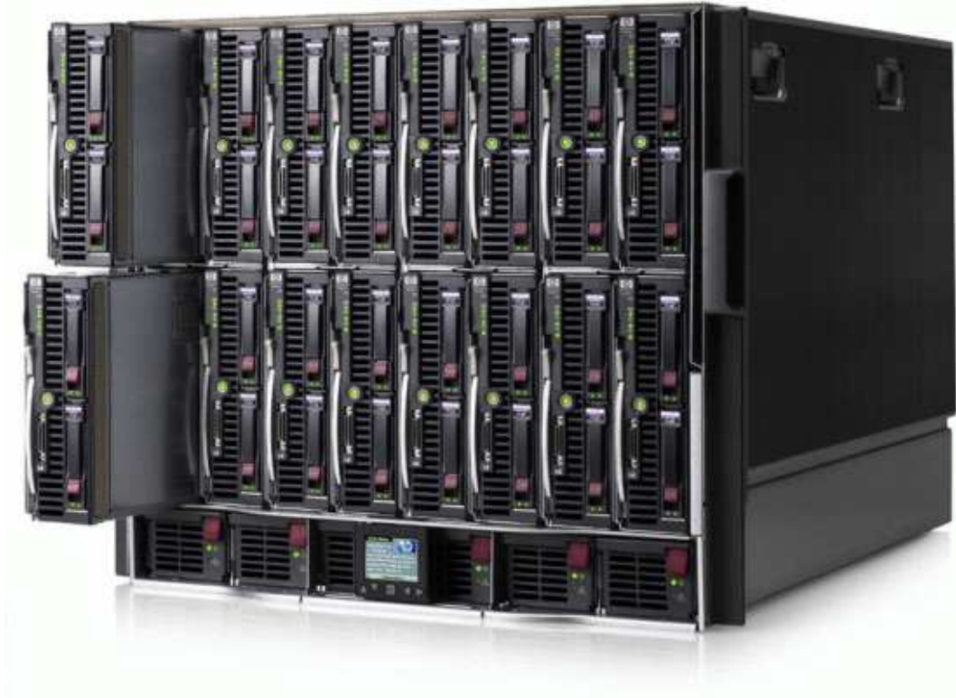
Slika 1: Omarica za strežniške rezine HP BLc7000 z upravljalnim modulom
