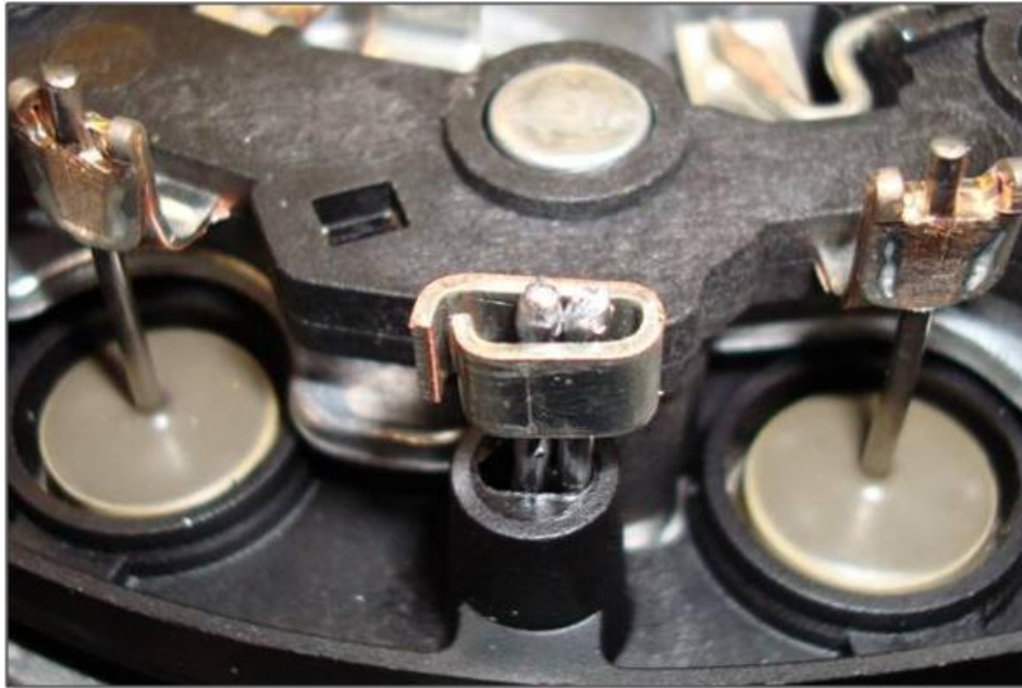
Slika 14: Stisnjena zanka z odcepoma statorja (Reklamacijski zapisnik, 2010)
