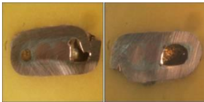
Slika 12: Prerez spoja spajkanega s spajko višjega tališča
