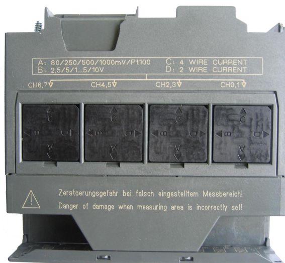
Slika 20: Nastavitveni mostički analognega vhodnega modula
