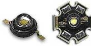
Slika 29: Izbrani LED diodi za novo svetilo (podjetje Luxeon Star, ZDA)
