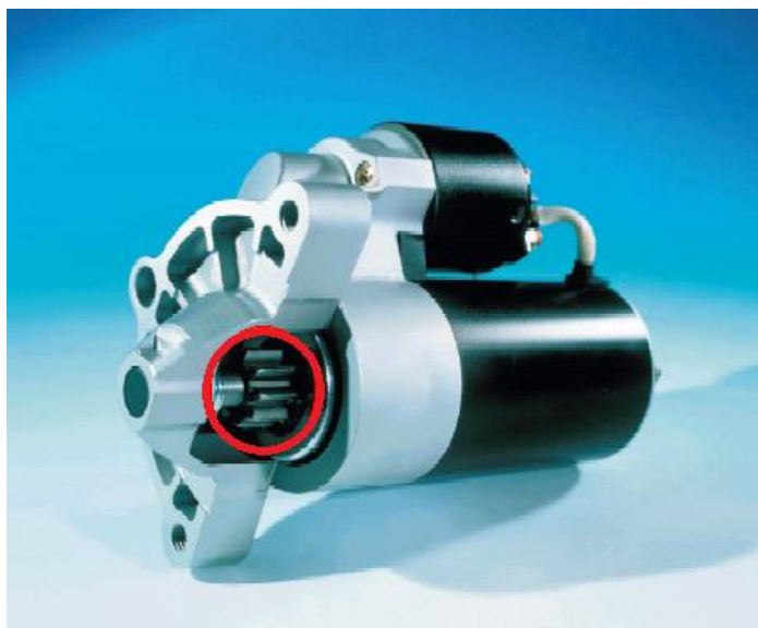
Slika 11: Vgradnja pastorka v zaganjalnik
