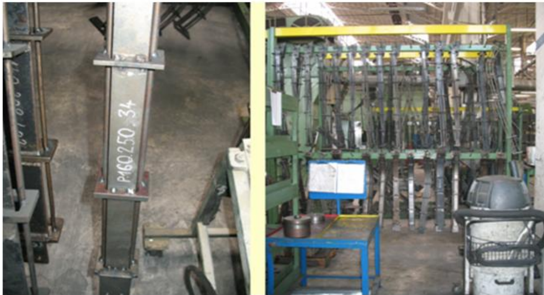
Slika 19: Seržerji označeni s P številko in razporejeni na svojih mestih v skladišču
