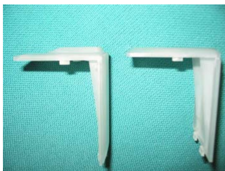
Slika 26: Prototip vratc končnika izdelan po postopku stereolitografije (Intra Lighting, 2005)
