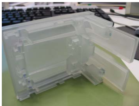
Slika 25: Prototip končnika izdelan po postopku stereolitografije (Intra Lighting, 2005)
