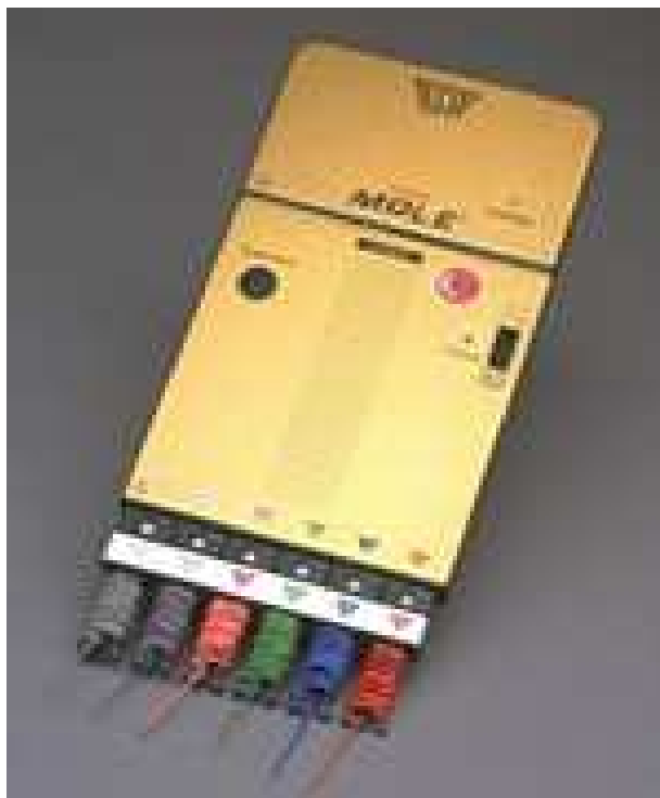
Slika 4: Merilna naprava Super M.O.L.E. Gold, ki smo jo uporabljali za meritve temperature (Mole, 2005)
