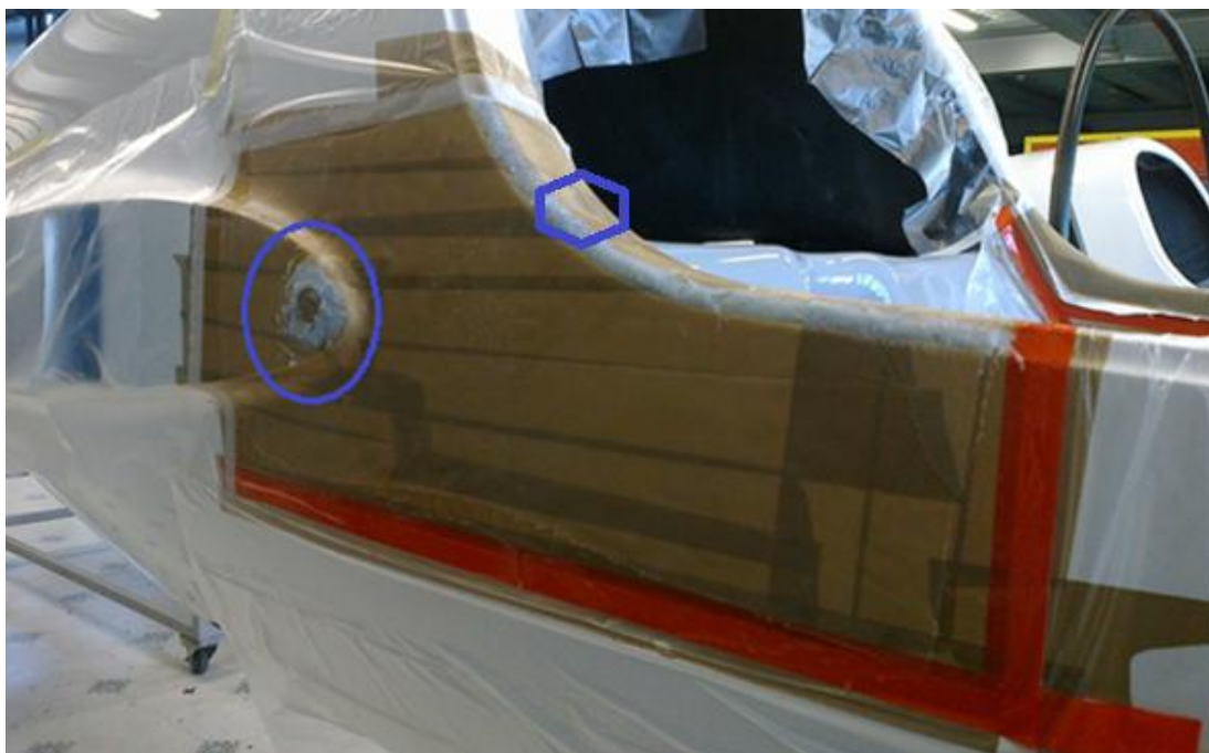
Slika 23: Izdelava priprave za zarisovanje lukenj in vgradnjo drsnih puš, 1. del
