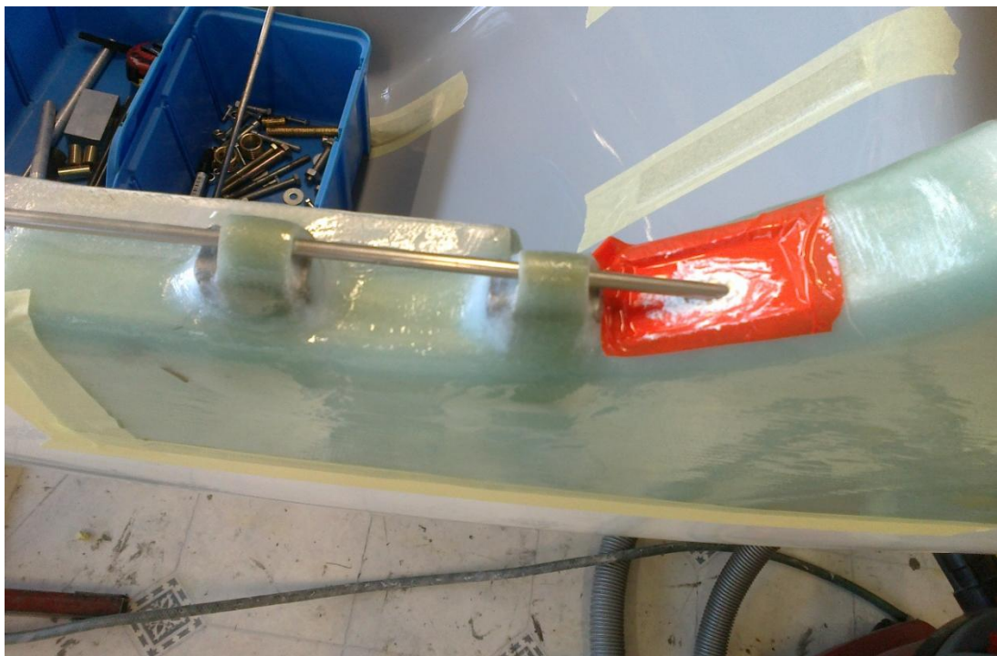
Slika 30: Vgrajena drsna puša v trupu
