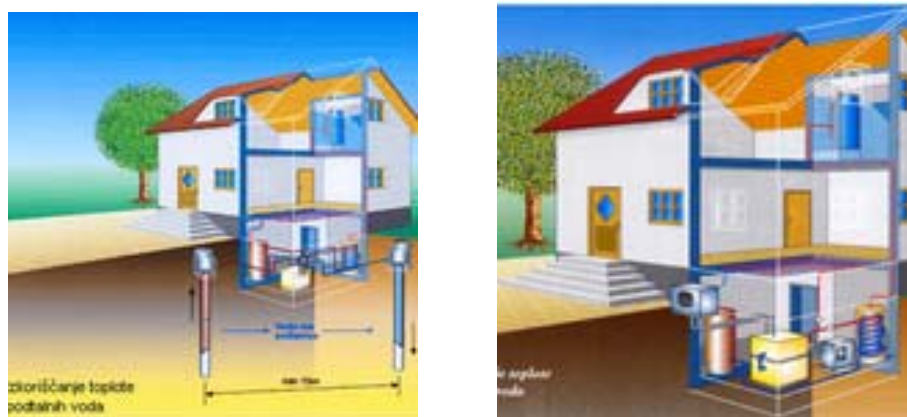
Slika 10: Shema toplotne črpalke voda-voda in zrak-voda (Termotehnika, 2011)
