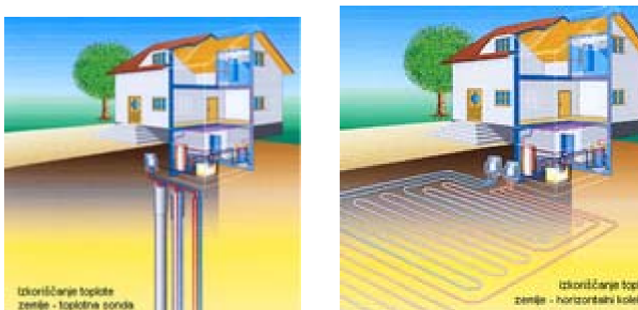
Slika 11: Shema toplotne črpalke zemlja-voda (Termotehnika, 2011)
