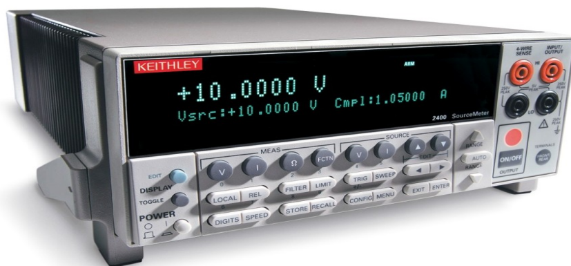
Slika 17: Laboratorijski merilnik izvora (slikovni vir: Keithley.com )
