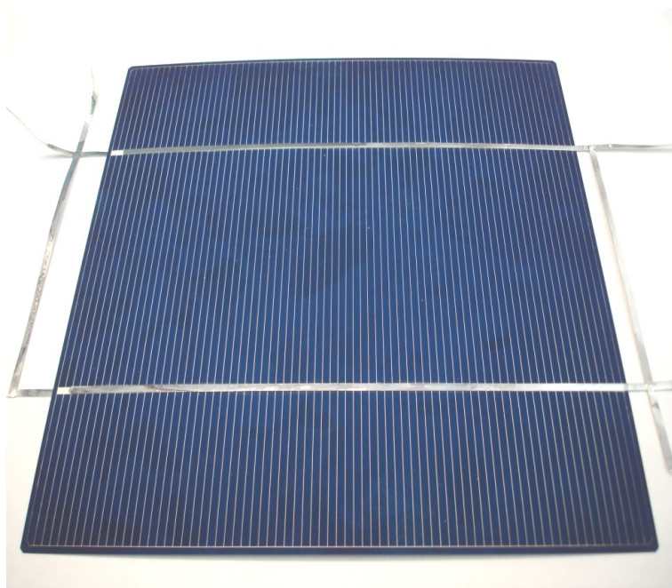
Slika 1: Polikristalna fotonapetostna celica dimenzije 156×156 mm
