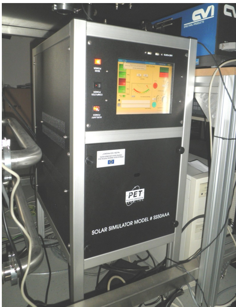
Slika 15: Sončni simulator z obločno ksenonsko žarnico
