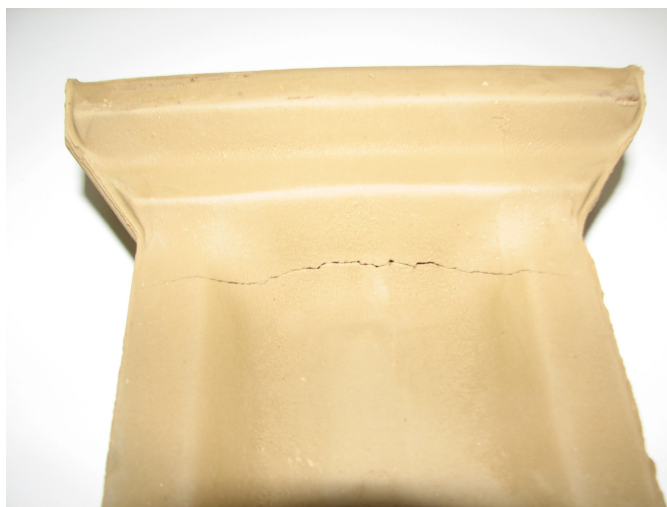
Slika 15: Razpoka zaradi previsoke plastičnosti gline
