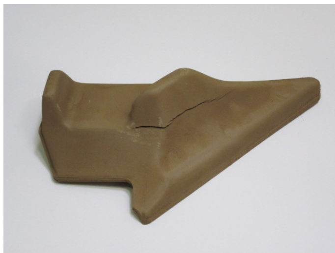
Slika 13: Razpoka na dodatnem opečnem elementu
