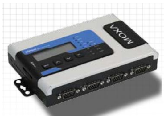
Slika 25: Pretvornik RS 485 / Ethernet, MOXA, serija NPort 6450 (Moxa, 2011)
