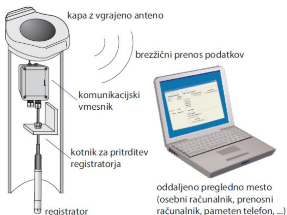
Slika 21: Brezžični prenos podatkov (Tehnični list, 2011)
