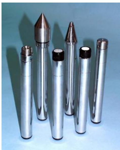
Slika 8: Senzor tlaka pri piezometru (Grebe, 2005)
