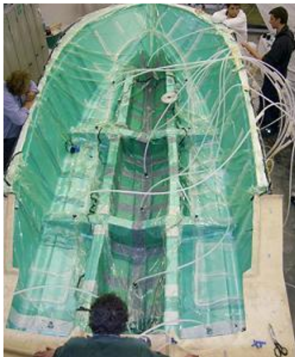
Slika 4: Praktičen prikaz infuzijskega postopka (Plovila Lexmar, 2011)
