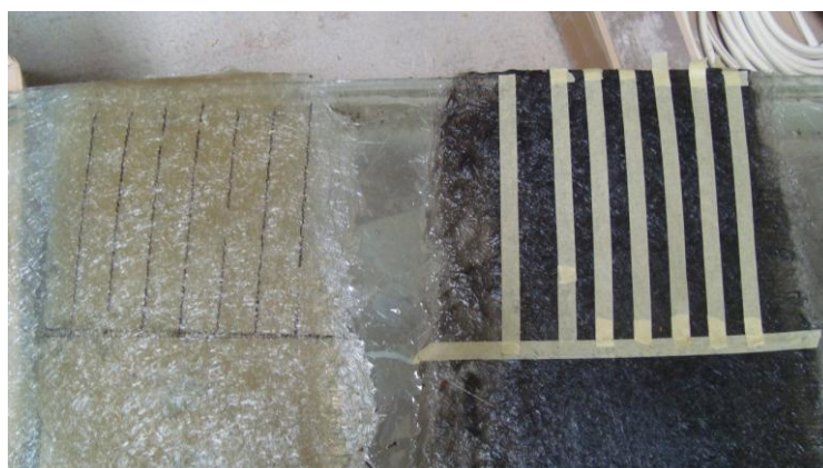
Slika 25: Prikaz postopka izdelave vzorcev materiala za natezni preizkus (levo material s primesjo fulerenov, desno material s primesjo ogljikovih nanocevk in fulerenov)
