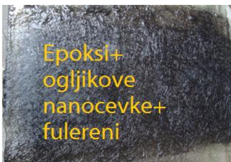
Slika 21: Material z implementiranimi fulereni in ogljikovimi nanocevkami (NN+FU)
