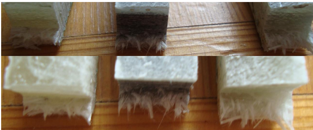
Slika 33: Primeri lomnih površin vzorcev novih materialov po opravljenem preizkusu na Charpyjevem kladivu
