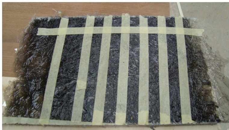
Slika 26: Prikaz postopka izdelave vzorcev materiala za natezni preizkus (material s primesjo ogljikovih nanocevk in fulerenov)
