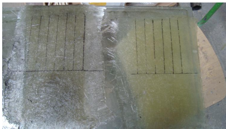
Slika 24: Prikaz postopka izdelave vzorcev materiala za natezni preizkus (levo: material s primesjo ogljikovih nanocevk, desno: klasičen epoksi material)
